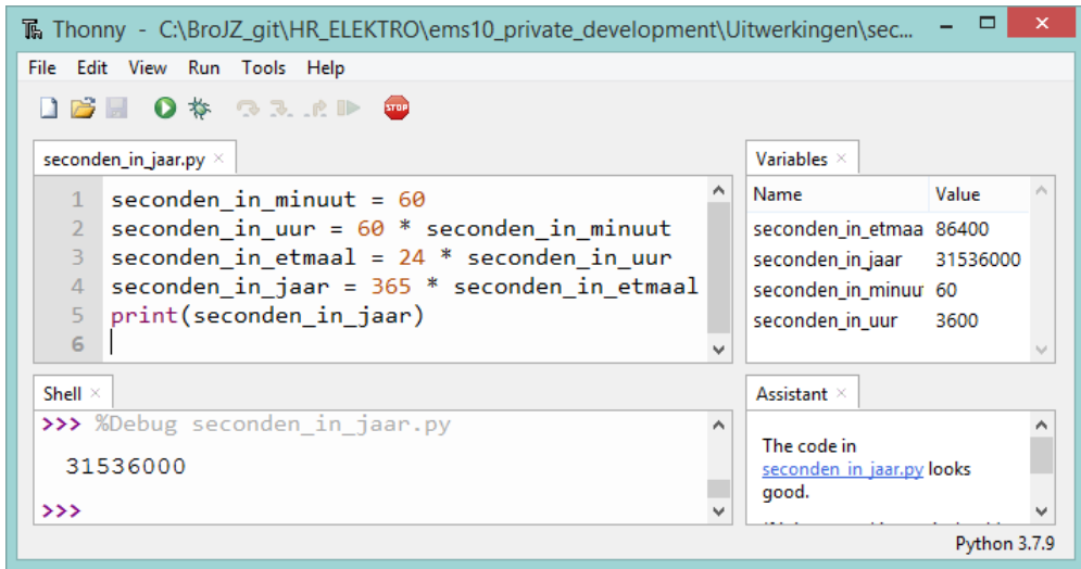
Figuur 7: In het Variables window kun je de waarden van de verschillende variabelen in je programma zien tijdens het stap voor stap uitvoeren van je programma.
