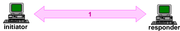
Figura 5.2: IKE phase 1 - negoziazione di una SA ISAKMP bidirezionale: “main mode” o “aggressive mode”
