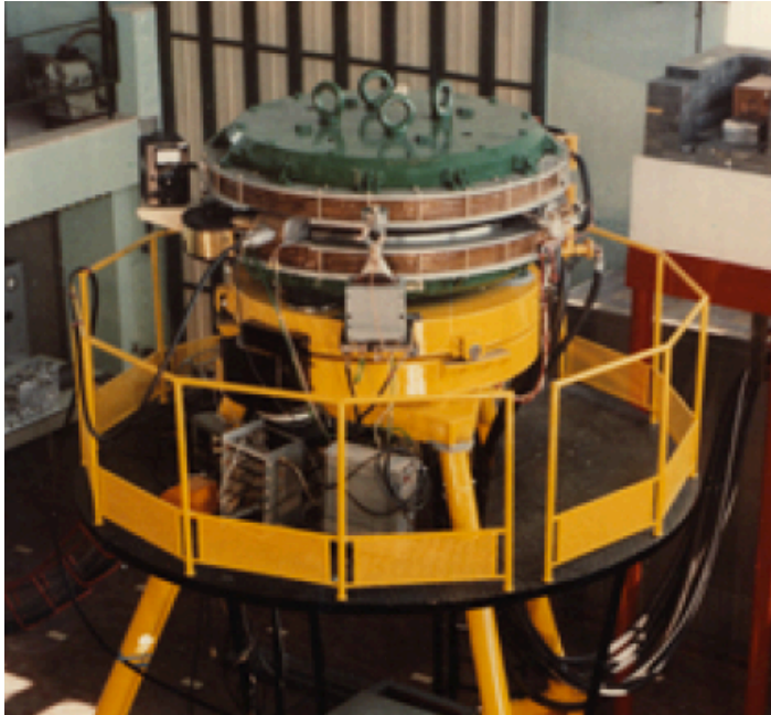
AdA (Anello di Accumulazione) First electron-positron collisions 250 MeV, 1.3 m diameter Frascati (1961) and Orsay (1964)
