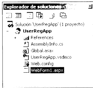
Figura 22.4. La ventana de proyecto muestra todos los archivos creados por el asistente de la aplicación Web.
