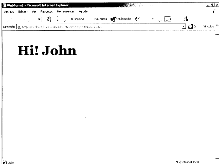
Figura 22.8. Cuando un usuario es redirigido a otra página, el nombre del usuario se pasa en la cadena de consulta.
